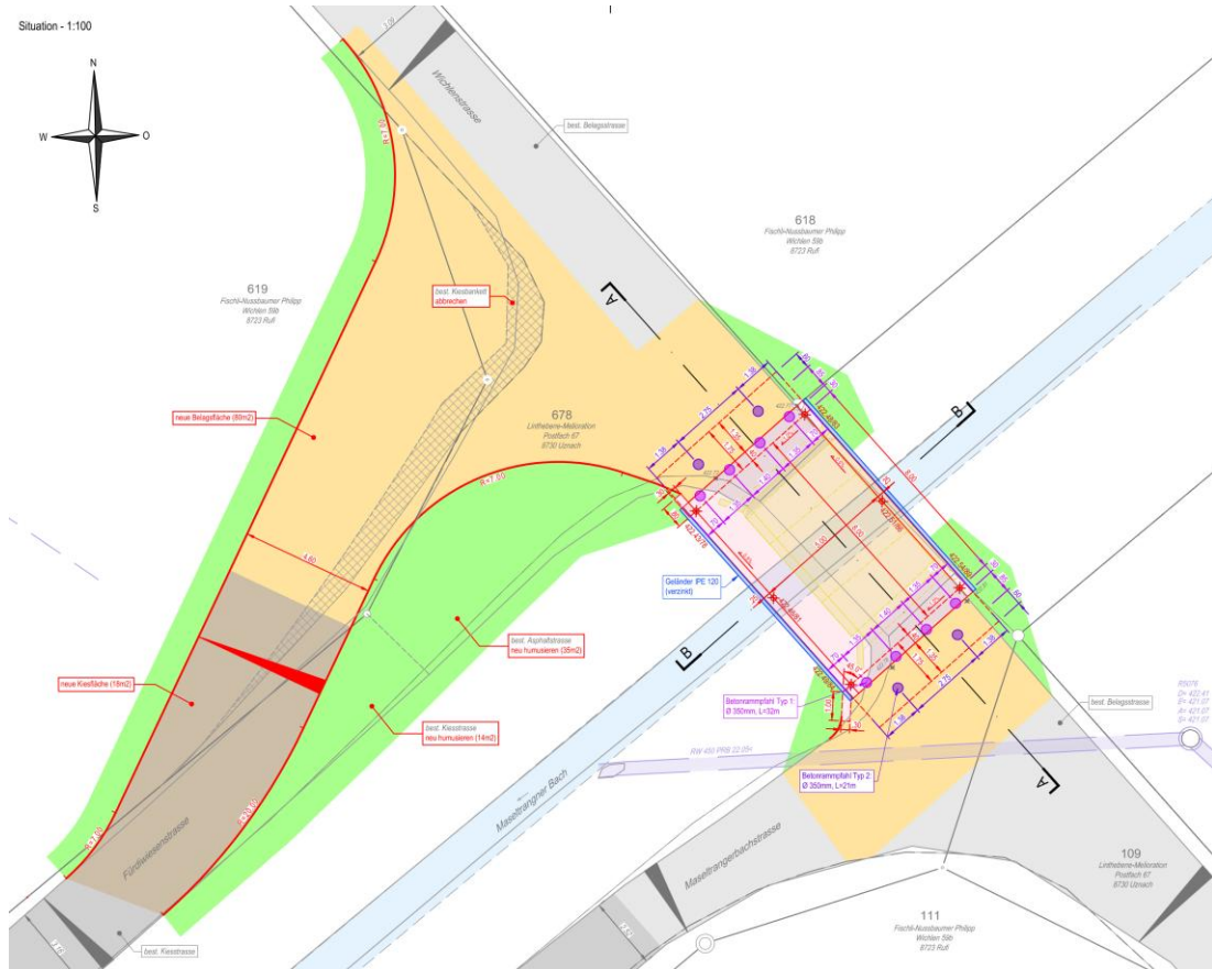
Abb. 11: Ausschnitt Projektplan, Situation Brücke und Belagsanpassung
