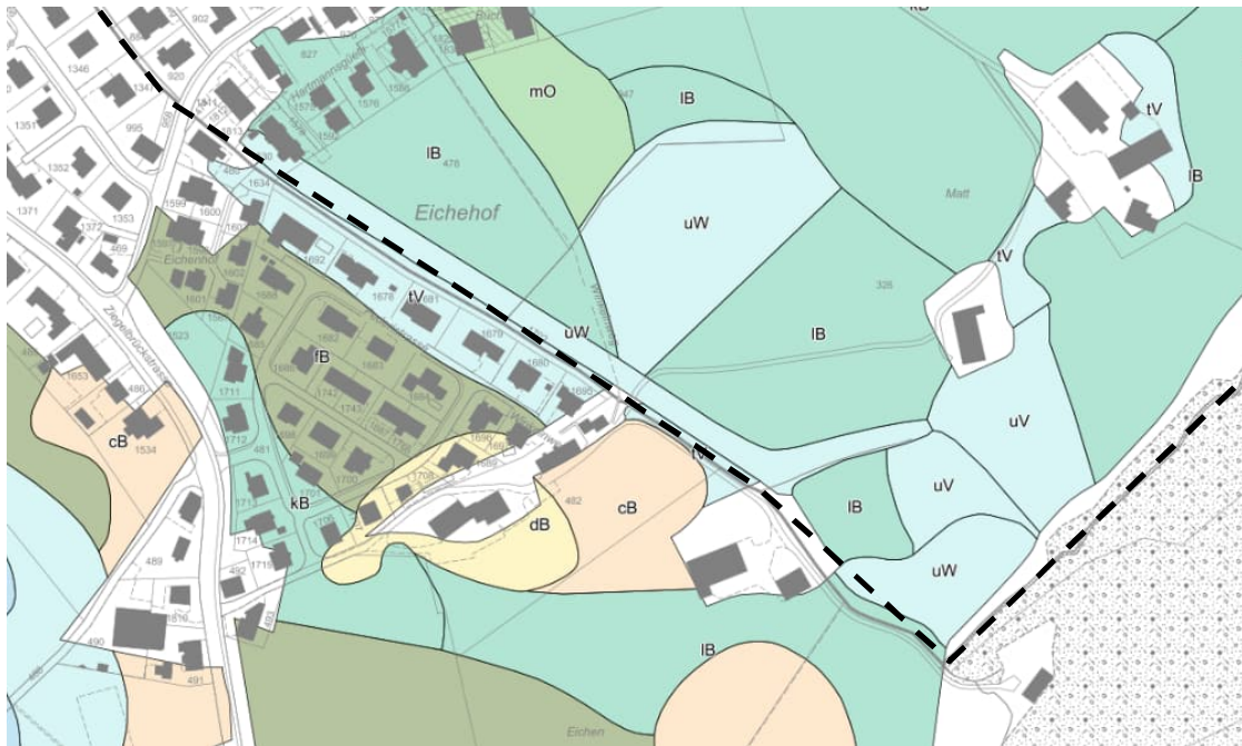
Abbildung 14: Auszug aus der Bodeninformationskarte Kt. SG, Abschnitt Bürgerheim/Eichehof (Quelle: geoportal.ch, Jan. 2022); B = Braunerde, I = Pseudogley, W = Buntgley, U = Mischgesteinsboden, schwarz-gestrichelt = Ausbaustrecke Hofbach.
