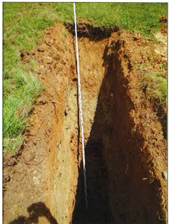
Abb. 5 und 6: Baggerschlitzsondierungen BS1 (links) und BS2 (rechts) mit den hellgrauen Stillwasserablagerungen und den beigebräunten Kiessanden.
