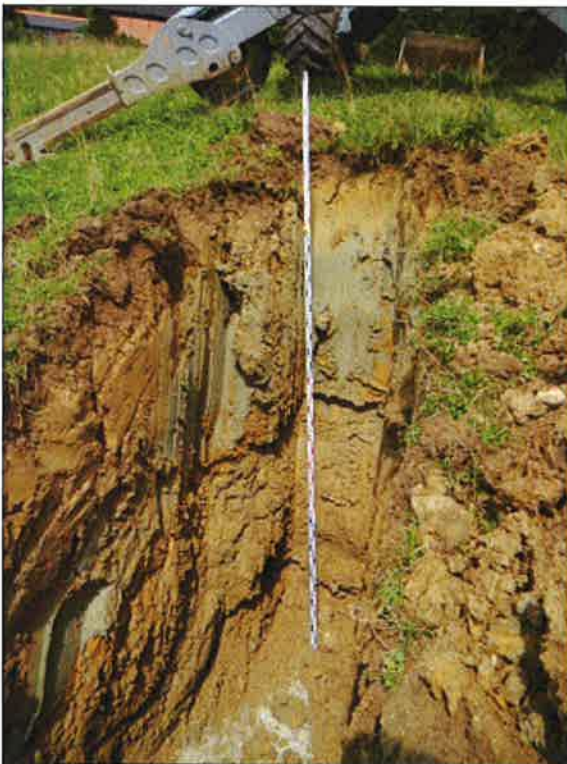
Abb. 5 und 6: Baggerschlitzsondierungen BS1 (links) und BS2 (rechts) mit den hellgrauen Stillwasserablagerungen und den beigebräunten Kiessanden.
