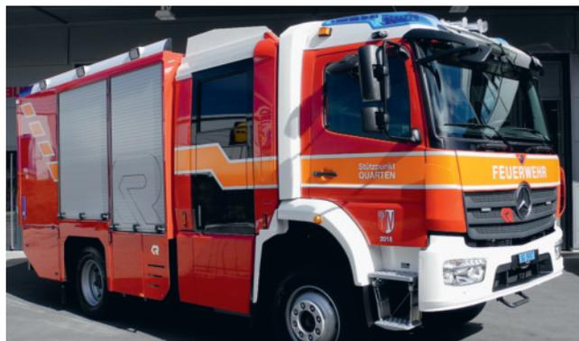
Das neue Rüstfahrzeug baut auf einem Mercedes-Benz-Fahrgestell Typ Atego 1530 AF 4x4 auf und
